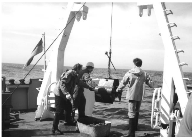
Рис. 7 НИС «Профессор Водяницкий», Чёрное море. Отбор макробентоса с помощью дночерпателя «Океан-50» Fig. 7 RV “Professor Vodyanitsky, Black Sea. Sampling macrobenthos with grab “Ocean-50”
